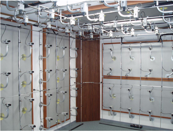
図3 包囲型マイクロホンアレイの概観図 [20]
