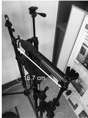
図 9 実験に用いた超指向性マイクロホン Fig. 9 Hyper-directional microphone used in the experiment.
