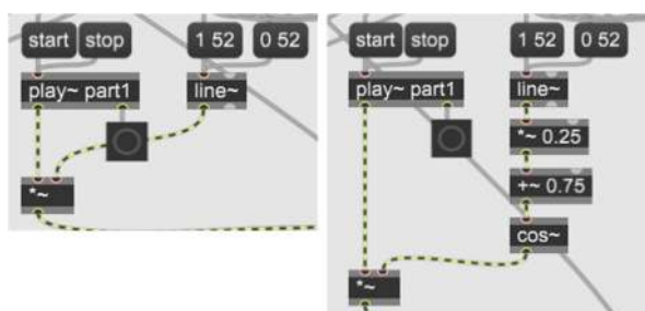
Fig. 3 Max を用いたクロスフェード法 (左：三角窓，右：cos 窓)
